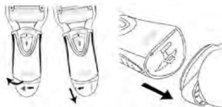
2. Mettez deux piles AA dans le compartiment des piles, en respectant le sens de polarité indiqué derrière la poignée.
