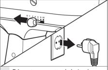
Démontage : mettez le levier de contrôle de la vitesse en position « 0 ». Débranchez le robot pâtissier.
