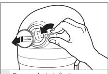
Desserrez la vis de fixation des accessoires en la tournant dans le sens inverse des aiguilles d'une montre. Enlevez le couvercle du moyeu de fixation.
