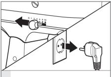
Mettez le levier de contrôle de la vitesse en position « 0 ». Débranchez le robot pâtissier.
