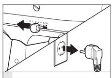
Fixation: mettez le levier de contrôle de la vitesse en position « 0 ». Débranchez le robot pâtissier.
