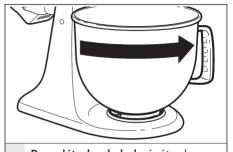
Pour détacher le bol: répétez les étapes 1 et 2. Tournez doucement le bol dans le sens inverse des aiguilles d'une montre.
