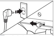
Branchez le robot pâtissier dans une prise électrique adéquate. Pour commencer, placez toujours le levier de contrôle de vitesse sur la position la plus basse, puis augmentez-la progressivement afin d'éviter les éclaboussures. Consultez le « Guide de sélection des vitesses »
