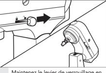
Maintenez le levier de verrouillage en position de déverrouillage et soulevez la tête.
