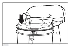
Depuis l'avant du robot pâtissier, faites glisser le couvercle verseur/protecteur sur le bol jusqu'à ce qu'il soit centré. Le bord inférieur du couvercle verseur/protecteur devrait s'ajuster au bol.
