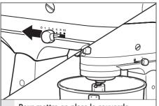
Pour mettre en place le couvercle verseur/protecteur : mettez le levier de contrôle de la vitesse en position « 0 » Débranchez le robot pâtissier. Fixez l'accessoire souhaité. Consultez la section « Fixation/retrait du batteur plat, du batteur plat à bord flexible, du fouet à fils ou du crochet pétrisseur ».
