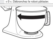
Placez le bol sur la plaque de verrouillage. Tournez délicatement le bol dans le sens des aiguilles d'une montre.
