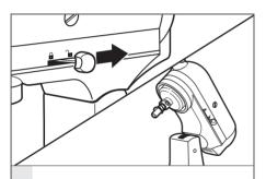
Maintenez le levier de verrouillage en position de déverrouillage et soulevez la tête
