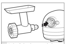
Insérez l'arbre de commande de l'accessoire dans le moveu de fixation des accessoires, en vous assurant que l'arbre s'emboîte bien dans l'embase carrée du moyeu de fixation. Il peut s'avérer nécessaire de faire pivoter l'accessoire. S'il est bien placé, le pignon situé sur l'accessoire s'emboîte dans l'encoche sur le rebord du moveu.
