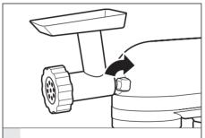
Serrez la vis de fixation des accessoires en la tournant dans 4 le sens des aiguilles d'une montre jusqu'à ce que l'accessoire soit complètement fixé au robot pâtissier.
