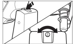
Levez la tête du robot. Tournez la vis légèrement dans le sens inverse des aiguilles d'une montre (vers la gauche) pour lever le batteur plat ou dans le sens des aiquilles d'une montre (vers la droite) pour abaisser le batteur plat. Réglez le batteur plat jusqu'à ce qu'il soit au ras du fond du bol. Si vous ajustez la vis de manière excessive, le levier de verrouillage du bol pourrait ne pas se verrouiller.
