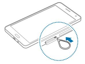
Assurez-vous que l'outil de retrait est perpendiculaire à l'orifice. Dans le cas contraire, l'appareil pourrait être endommagé.
