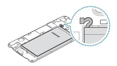
6 Appuyez sur la partie arrière de la batterie et retirez la batterie.
