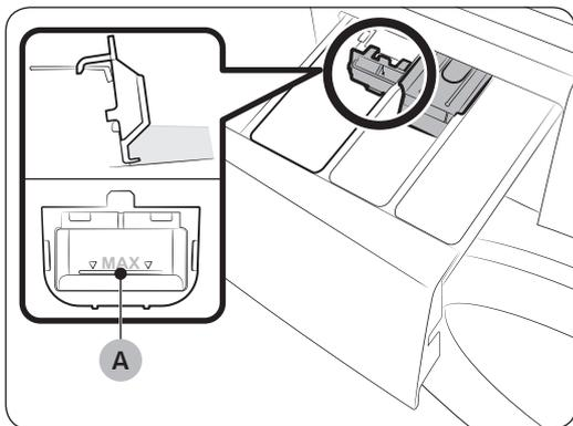
Insérez d'abord le guide à lessive liquide fourni dans le **II** compartiment de lavage principal. Versez ensuite de la lessive liquide dans le guide en veillant à ne pas dépasser le **trait de remplissage maximum (A)**.
