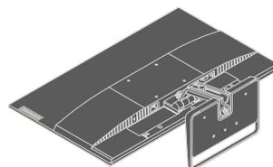
Étape 4 : Fixez le support de montage provenant du kit de montage mural compatible VESA (distance de 100 mm x 100 mm), vis de montage VESA M4 x 10 mm.
