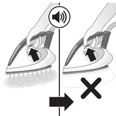
En outre, pour protéger la centrale vapeur du calcaire, la fonction vapeur est désactivée si le traitement anticalcaire n'est pas réalisé. La fonction vapeur est réactivée après le traitement anticalcaire. Le traitement anticalcaire est nécessaire quel que soit le type d'eau utilisé.
