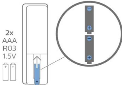
3 - Repositionnez le couvercle du compartiment à piles et faites-le glisser jusqu'à ce qu'il s'enclenche.
