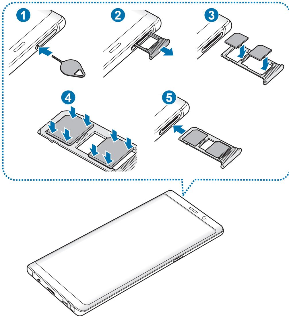
1 Insérez l'outil de retrait à l'endroit prévu à cet effet sur le compartiment pour le déverrouiller.
