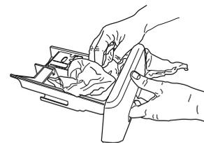
5. Remplacez le distributeur de lessive et poussez-le en place dans le compartiment de lessive.
