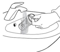
6. Insérez le filtre à eau et réinstallez la plinthe : Replacez le filtre à eau en le tournant dans le sens horaire. Assurez-vous de le tourner aussi loin que possible ; la poignée du filtre doit être en position verticale. Pour vérifier l'étanchéité du filtre à eau, vous pouvez verser environ 1 litre d'eau dans le distributeur de lessive. Replacez ensuite la plinthe.
