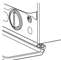
3. Vidanger l'eau : Tournez lentement le filtre dans le sens contraire des aiguilles d'une montre jusqu'à ce que de l'eau ressorte. Laissez l'eau se vidanger sans enlever le filtre. Lorsque le récipient est plein, fermez le filtre à eau en le tournant dans le sens horaire. Videz le récipient. Répétez cette procédure jusqu'à ce que toute l'eau soit vidangée.
