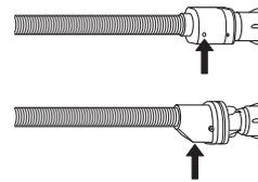
Pour les tuyaux d'arrêt d'eau : vérifiez la fenêtre d'inspection de la petite soupape de sécurité (voir la flèche). Si elle est rouge, la fonction d'arrêt d'eau a été déclenchée et le tuyau doit être remplacé.
