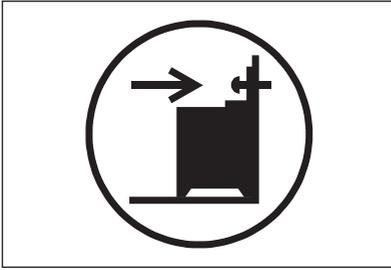
1. Installez la protection anti-bascule 232 - 237 mm en-dessous de la surface supérieure de l'appareil et à 110 - 115 mm à côté de l'appareil, dans l'orifice circulaire situé sur un support. Vissez-la dans un matériau solide ou utilisez un renfort adapté (mur).
