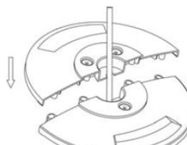
3. Insérez le câble d'alimentation dans le trou central constitué lors de l'assemblage des deux parties du socle.
