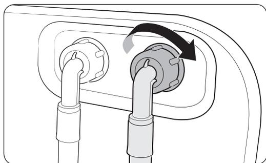
1. Raccordez l'extrémité rouge du tuyau d'eau chaude à la vanne d'arrivée d'eau chaude située à l'arrière du lave-linge.
