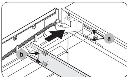
9. Insérez le cache du cadre supérieur avec la pièce (b) insérée dans la pièce (a), en diagonale.
