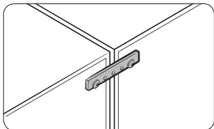
4. Rejoignez les côtés supérieurs et inférieurs des deux réfrigérateurs à l'aide des **charnières arrière renforcées** et des **vis taraudeuses**.
