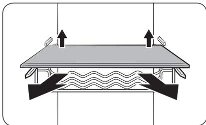
Soulevez légèrement l'arrière de la clayette (ou du casier à bouteilles de vin) pour la/le retirer.
