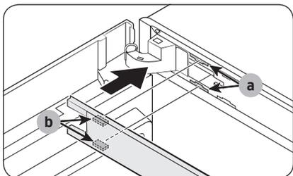
9. Insérez le **cache du cadre supérieur** avec la **pièce (b)** insérée dans la **pièce (a)**, en diagonale. Ensuite, faites glisser l'extrémité du cache vers la gauche pour le verrouiller en place.
