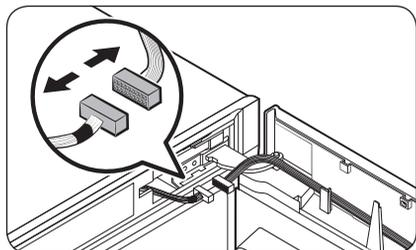
3. Débranchez les connecteurs situés sur ou autour de la porte du réfrigérateur. Desserrez les vis au niveau de la **charnière supérieure** pour la retirer.
