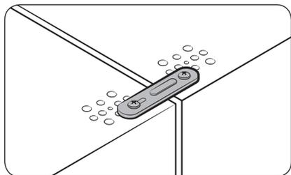
3. Rejoignez les côtés supérieurs des deux réfrigérateurs à l'aide du **crochet de fixation** et des **vis taraudeuses**.
