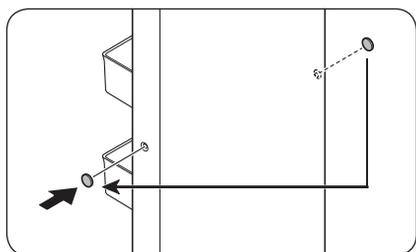
3. Utilisez un tournevis à tête plate pour retirer les obturateurs des vis de la poignée (x2). Ensuite, placez les obturateurs des vis de la poignée sur le côté opposé.
