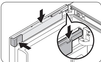
10. Insérez le **cache des câbles** à travers le **cache de la clé électronique** qui est ouvert. Tournez le cache de 90 degrés vers l'avant, puis poussez-le vers le bas pour le mettre en place.
