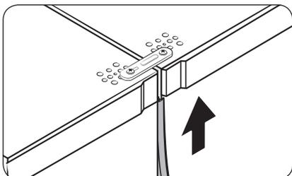
5. Rejoignez les pieds des deux réfrigérateurs à l'aide de la charnière inférieure renforcée et des vis taraudeuses.
