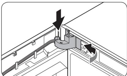
8. Insérez le **cache de charnière supérieure**, en commençant par le côté droit. Ensuite, pressez le bas du cache pour le mettre en place.
