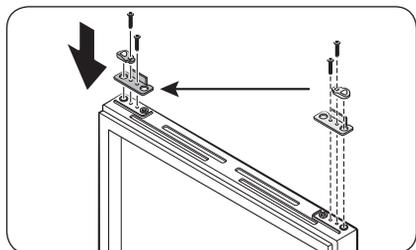
1. Sur la porte du réfrigérateur, retirez le levier du système de fermeture automatique en desserrant les vis sur le levier et les vis sur le côté opposé.
