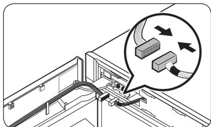
7. Branchez les connecteurs au niveau de la porte du réfrigérateur et de l'unité principale. Ensuite, fixez les câbles en place sur le crochet interne du cache de charnière (gauche) en option.
