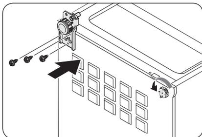
1. Allongez au sol le réfrigérateur avec précaution. Ensuite, retirez les vis au niveau de la **charnière inférieure** sur le côté droit et le **piéd de mise à niveau** sur le côté gauche, respectivement.
