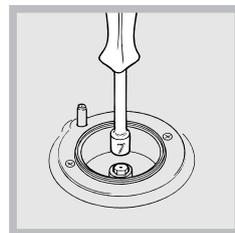
2. dévissez les injecteurs à l'aide d'une clé à tube de 7mm (voir figure), et remplacez-les par les injecteurs adaptés au nouveau type de gaz (voir tableau Caractéristiques des brûleurs et des injecteurs) ;
