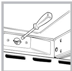
4. dévisser l'injecteur du brûleur à l'aide de la clé à tube spéciale pour injecteurs (*voir figure*) ou d'une clé à tube de 7 mm et le remplacer par l'injecteur adapté au nouveau type de gaz (*voir tableau Caractéristiques des brûleurs et des injecteurs*).
