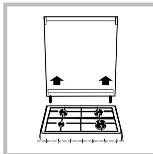
Pour le nettoyage des modèles équipés de couvercle en verre, utilisez de l'eau tiède. Évitez tout produit abrasif. Vous pouvez déposer le couvercle pour simplifier le nettoyage de la zone arrière du plan de cuisson : ouvrez-le
