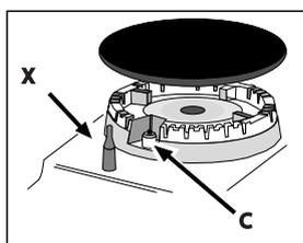
Si l'appareil est équipé d'un allumage électronique\* (C) il suffit de pousser et de tourner en même temps dans le sens inverse des aiguilles d'une montre le bouton BRULEUR sur le symbole petite flamme,
