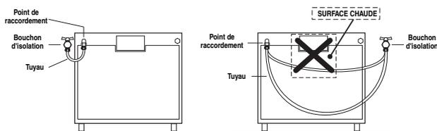
! Si une ou plusieurs de ces conditions ne peuvent être remplies ou que la cuisinière est installée dans des conditions de classe 2 – sous-classe 1 (appareil encastré entre deux meubles), il faut utiliser un tuyau flexible en acier (voir ci-dessous).
