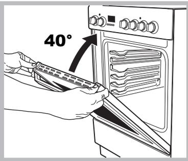
4. Appuyer sur les deux boutons placés sur le profil supérieur et retirer le profil (voir photo)
