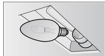
3. Remettre le couvercle de l'ampoule en place.
