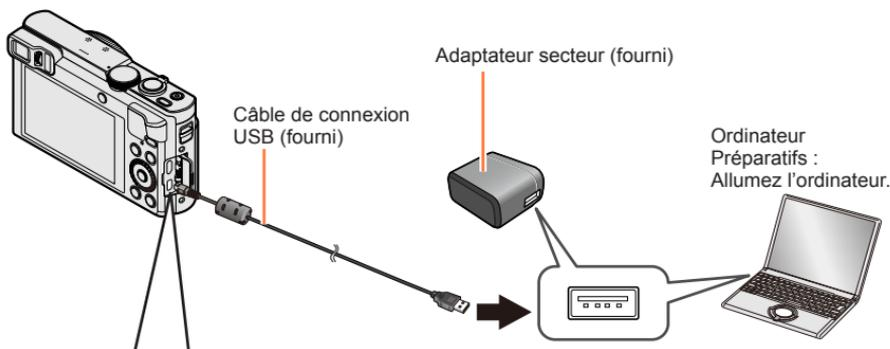
**Lorsque vous chargez l'appareil photo, branchez le câble de connexion USB (fourni) dans la prise [AV OUT/DIGITAL].**
