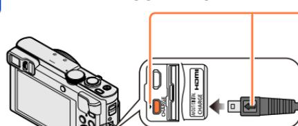
Vérifiez le sens de la fiche, et insérez-la bien droit. (En insérant la fiche du cordon dans le mauvais sens, vous risqueriez de la déformer et de causer un dysfonctionnement.) Évitez aussi d'insérer dans la mauvaise prise. Cela risquerait d'endommager l'appareil.
