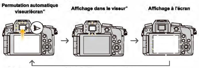
\* Si la [Détecteur viseur AF] dans le menu [Personnel] est sur [OUI], l'appareil photo règle automatiquement la mise au point car le capteur de l'œil est activé. (P58)
