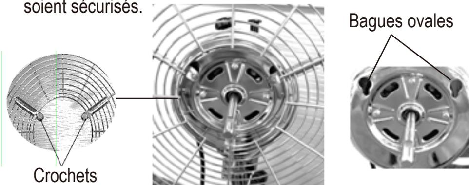
3. Alignez le troisième crochet de la grille arrière avec le trou de vis du moteur et fixez-le en serrant la vis.
