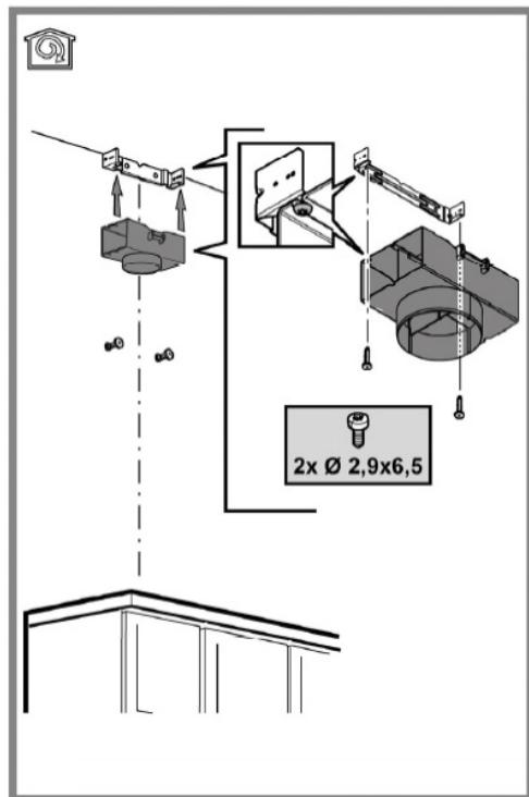
6. Positionnez la hotte sur les 2 vis du haut. Ouvrez la trappe des filtres à graisse afin d'accéder aux fixations des 2 vis situées à l'intérieur, de chaque côté. Retirez les filtres à graisse, puis positionnez les 2 vis intérieures à l'aide des rondelles fournies.
