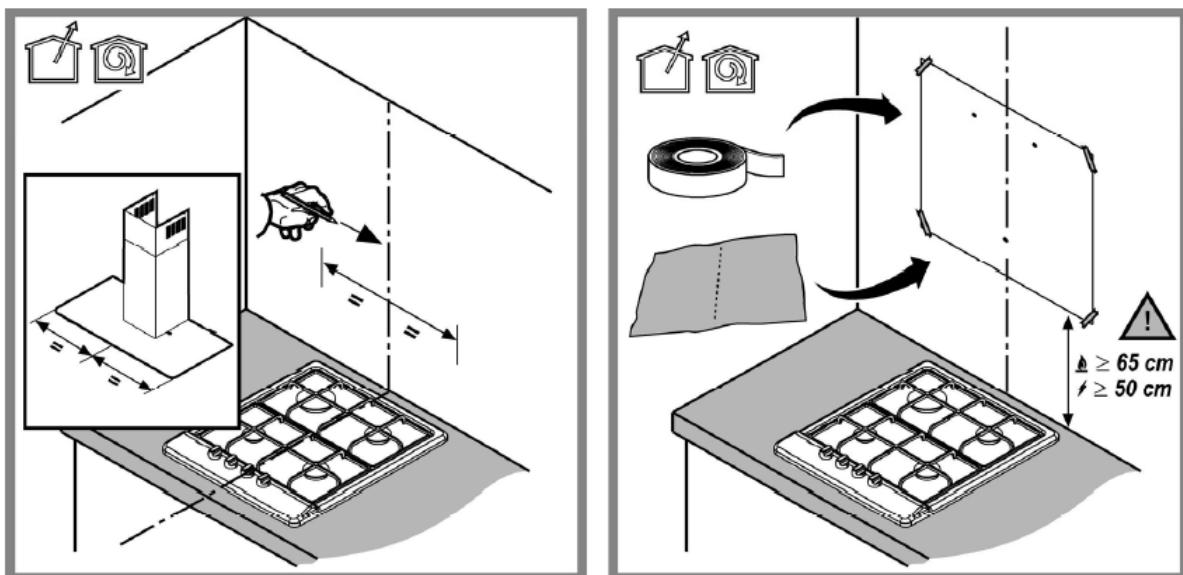
2. Marquez sur le mur l'emplacement des 4 trous figurant sur le gabarit, puis percez-les en utilisant une mèche de 8mm de diamètre.
