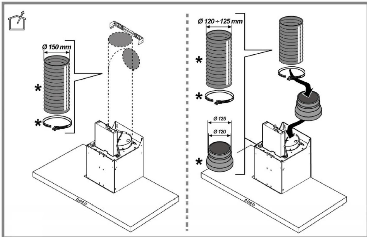
10. Étirez puis fixez la gaine au conduit de recyclage, ou reliez-la à l'évacuation extérieure. Dans le cas d'une évacuation extérieure, vous pouvez placer la valve anti-retour avant de positionner la gaine : cela évitera les retours d'air.
