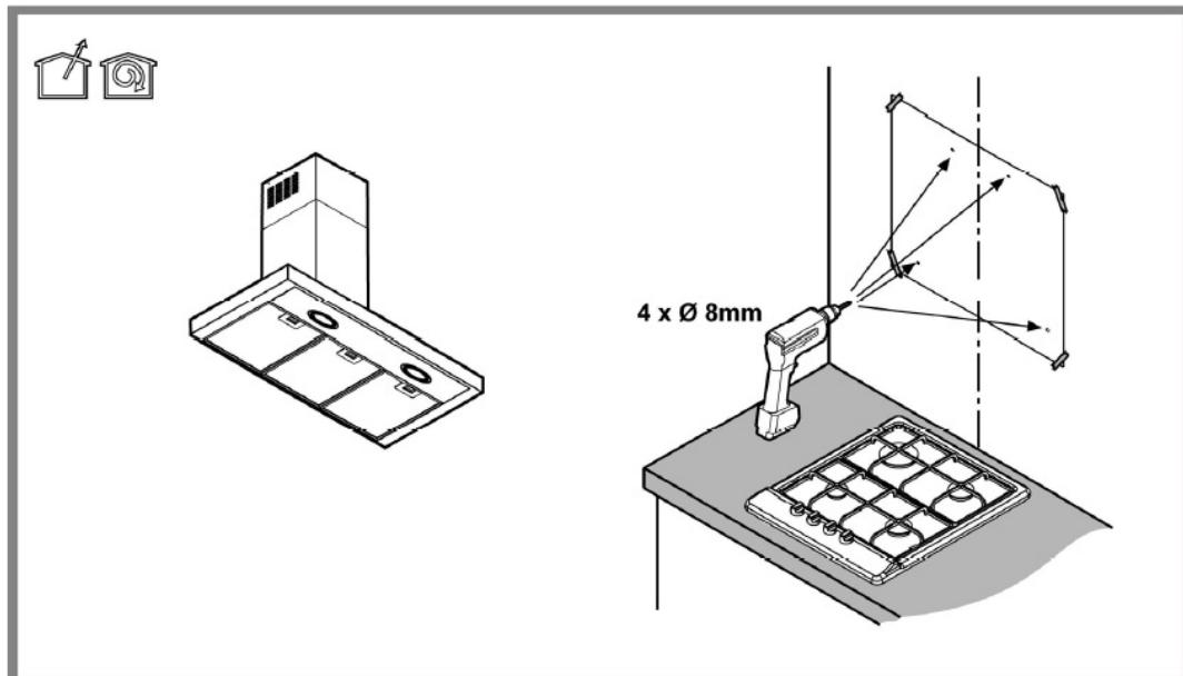
3. Dans les trous que vous venez de percer, insérez les 4 chevilles (diamètre 8mm, profondeur 40mm) puis les 4 vis (diamètre 5mm, profondeur 45mm) fournies.
