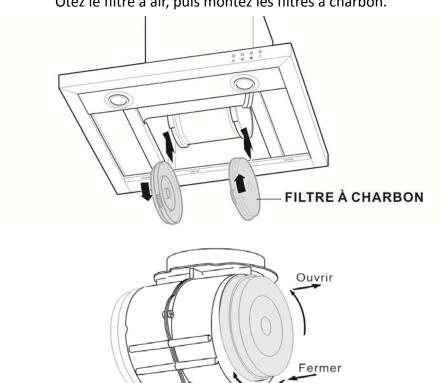
Une fois les filtres à charbon installés, remettez en place le filtre à air.
