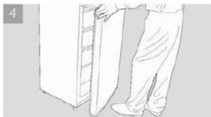
Décrochez la porte du gond inférieur. Faites basculer le réfrigérateur en arrière et posez-le à plat sur une surface solide.
