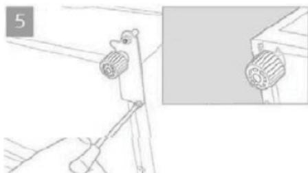
Démontez la charnière du bas en dévissant les vis. Montez le pied ajustable de gauche sur le côté droit.
