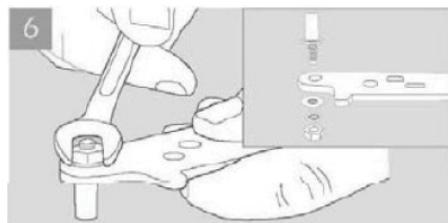
Démontez le gond de la charnière du bas à l'aide d'une clé. Retournez la charnière et réinsérez le gond dans le même trou. Montez la charnière de l'autre côté et remettez le réfrigérateur d'aplomb.
