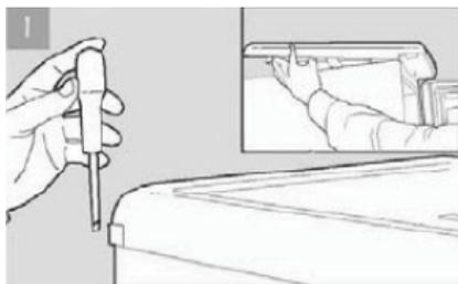
Démontez le panneau de dessus en dévissant les quatre vis situées à l'arrière.
