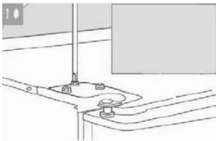
Remontez la porte du haut et remettez en place la charnière du haut. Ne serrez pas encore les vis à fond.
