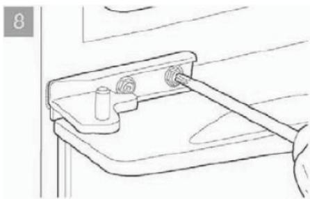
l'autre côté de la porte. Remontez la porte du bas et remettez en place la charnière du milieu; ne serrez pas à fond les vis de la charnière pour l'instant.
